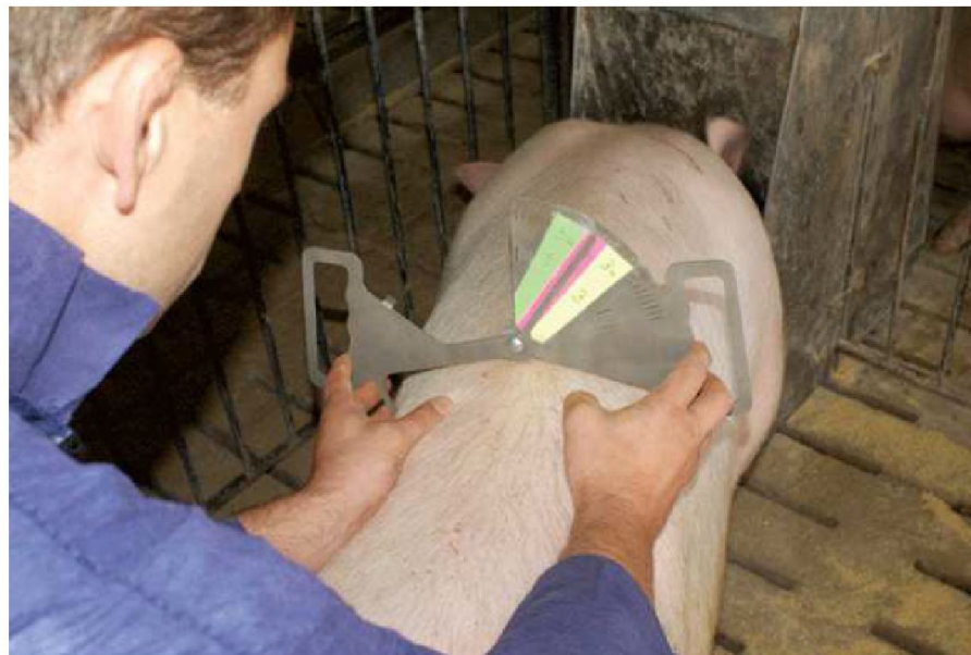
Fig. 1: Esempio di calibro per scrofa o sow caliper (fonte https://www.nationalhogfarmer.com/ )
